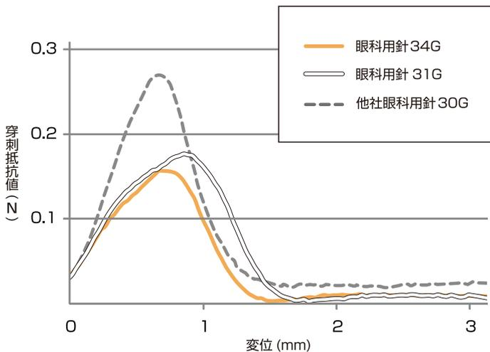
※ PAフィルム、試験速度200mm/min、ロードセル10Nで90°の方向に穿刺して測定。
